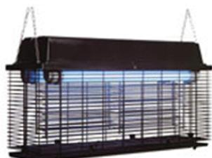
**Visokonaponske zamke za insekte** Uglavnom se proizvode modeli za industrijsku upotrebu, ali postoje i modeli manjih dimenzija za kućnu upotrebu. Način rada je sličan, kao kod zamki sa ventilatorom. Specijalna UV-A lampa privlači insekte a unutrašnja dobro zaštićena elektroda visokog napona (950-5000V) ih uništava. Zamke za insekte za domaćinstva: M-7104, M-7106, M-369. Industrijske zamke za insekte: M-7230, M-7280
